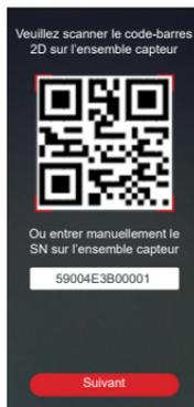
Après l'étape 4 de la section 2.1.2, scannez le code-barres SN 2D situé sur l'étiquette de l'ensemble capteur ou saisissez le code SN complet sur l'ensemble capteur en le tapant manuellement. Le code SN est unique au capteur et à l'émetteur, assurez-vous de saisir le code correct. Si vous saisissez un code erroné ou un code provenant d'un autre ensemble capteur, vous ne pourrez pas utiliser l'iCan i3 CGM ou votre résultat de glycémie pourrait être incorrect.
